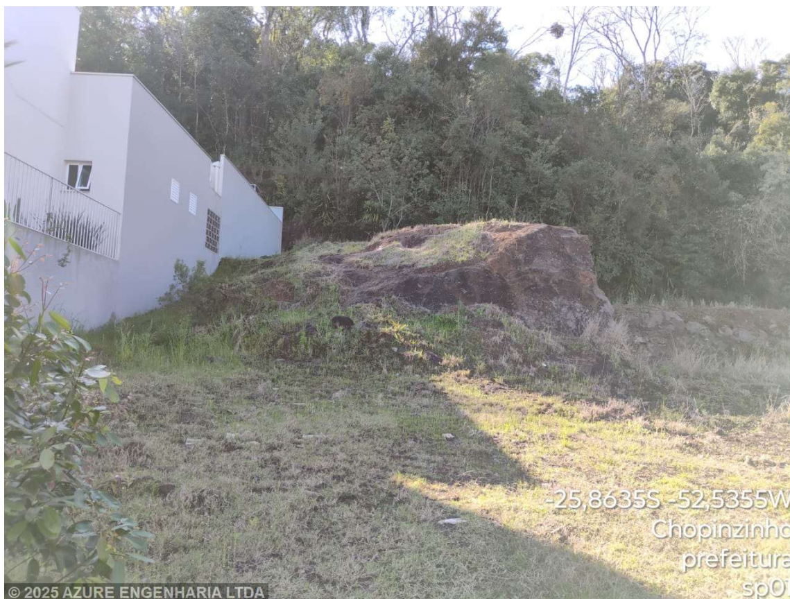
Foto 1 — Sondagem encerrada em 0,20 m por impenetrabilidade ao trado helicoidal, devido à presença de afloramento rochoso. Conforme NBR 6484:2020 (item 5.2.4.1), registro realizado por inspeção visual em campo.
