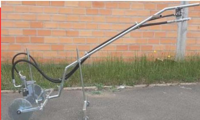
2-O carrinho manual: conjunto aplicador para fazer pintura manual de zebrados, passagens de pedestres e locais com difícil acesso a máquina etc. Produzidos totalmente em tubos de aço.
