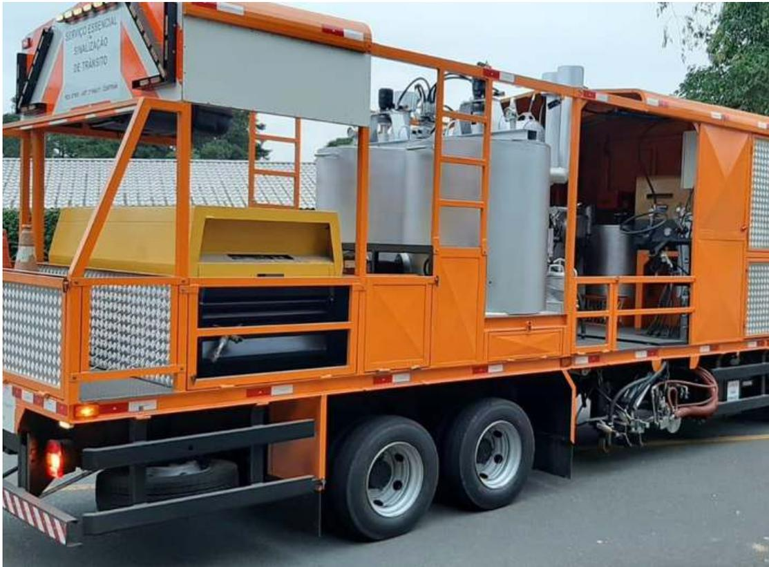
Esses equipamentos podem ser montado sob chassi de caminhão toco, caminhão 3/4 e caminhão trucado.
