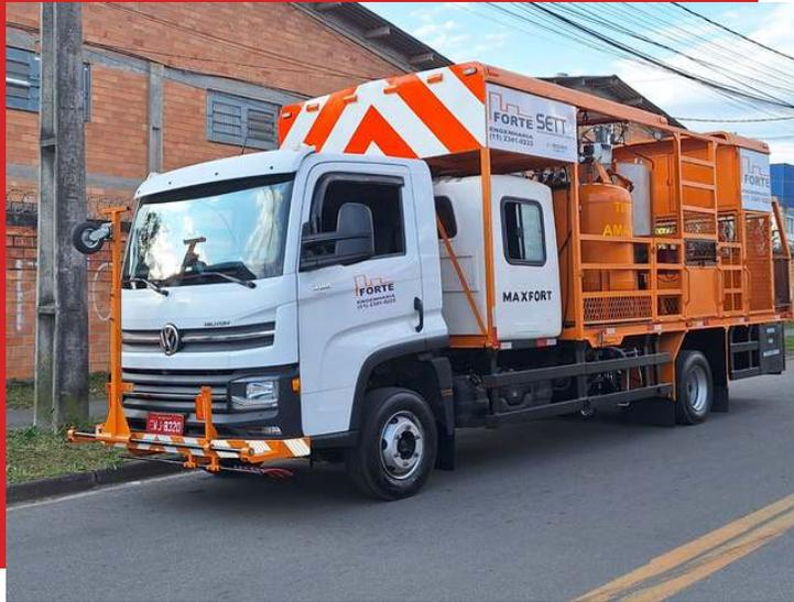
A tinta fria é aplicada por meio de um sistema mecanizado, garantindo precisão e eficiência. Já a tinta quente é aplicada manualmente, permitindo um controle ainda mais apurado sobre o processo.
