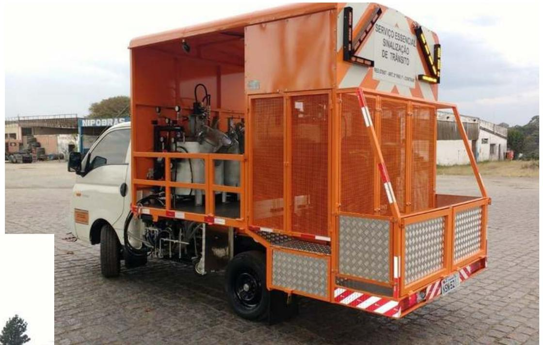
Possui 2 (dois) tanques de aço carbono galvanizado com capacidade de 120 litros cada. Sua autonomia é de aproximadamente 3,5 km de pintura com faixa de 10 em (equivalente 350m<sup>2</sup>).
