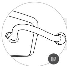
**INSIDE THE CHEMICAL TANK, CONNECT THE HOSE FOR LIQUIDS;**
