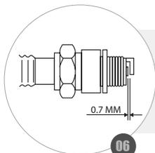
**CHECK THE SPACING BETWEEN THE ELECTRODE AND THE SPARK PLUG. IT MUST BE 0,6 AND 0,7 mm;**
