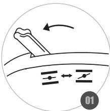
**MOVE THE CHOKE LEVER TO THE CLOSED;**
