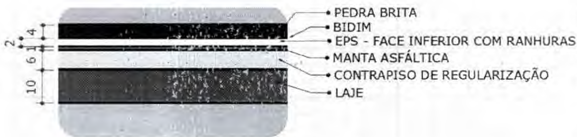
DETALHE LAJE IMPERMEABILIZADA 01 ESCALA: 1:10
