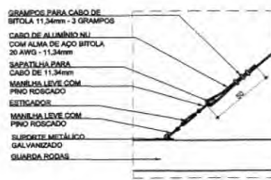
DETALHE TIRANTES Escala 1:20
