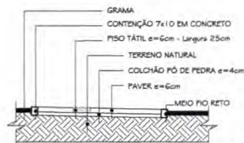
CORTE GENÉRICO PAVIMENTAÇÃO PAVER S/ Escala
