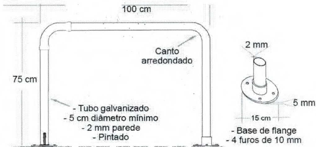
Figura 51 Especificação de Bicletário.
