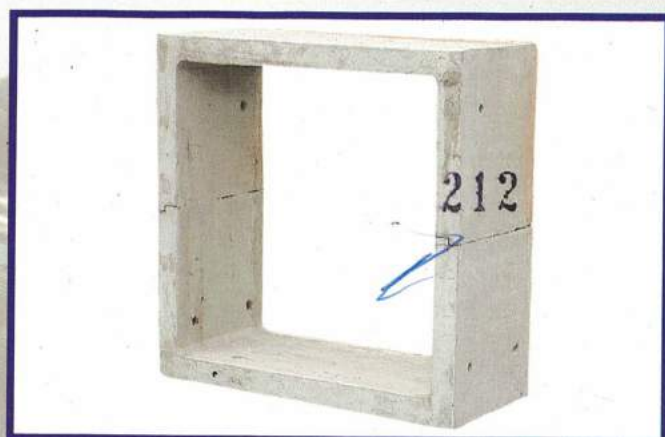
► Galeria e passa gado pré-fabricado com dimensões úteis de 2,00 X 1,50m / 2,00 X 2,00m / 2,50X2,00m / 2,50X2,50m 3,00 X 3,00m, nas mais variadas alturas de aterro, proporcionando economia de concreto e mão de obra.
