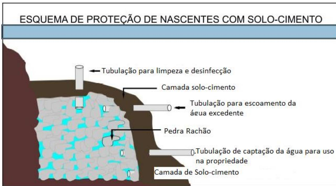
**Figura 01** – Esquema para proteção da nascente com solo-cimento.
